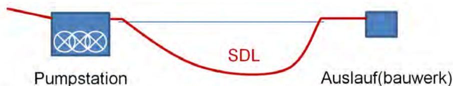
Abbildung 26: Pumpengestützter Abwassertransport durch die SDL.
