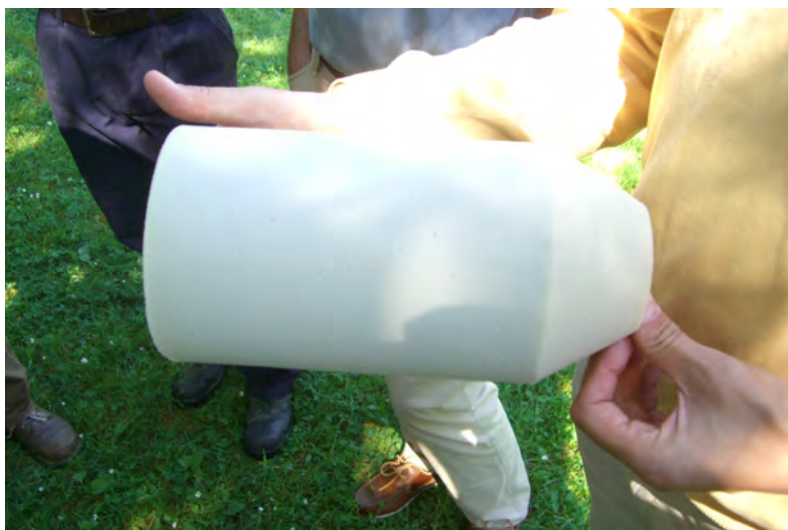
Abbildung 64: Für die Reinigung verwendeter Schaumstoffmolch.
