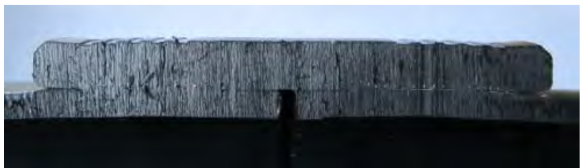
Abbildung 10: Elektromuffen-Schweißung; Rechts: Querschnitt durch die Schweißnaht (Bruckner, 2015).
