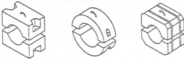
Abbildung 12: Bauformen unterschiedlicher Beschwerungsgewichte für SDL aus PE (Bildquelle: Brömstrup, 2001).
