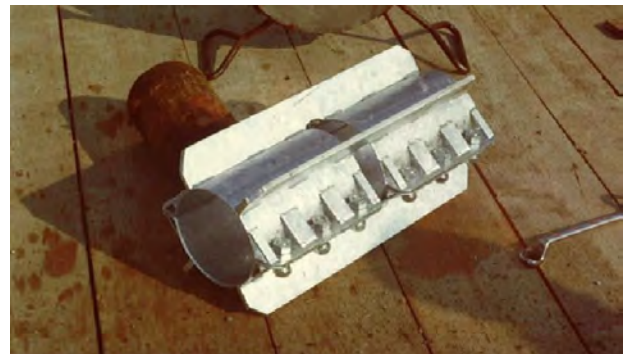
Abbildung 7: Mit Hilfe einer Metallkonstruktion biegesteif gesicherte Verbindung (Bildquelle: Links: Flanschverbindung beim Attersee, Rechts: Spiegelschweißung beim Ossiacher See).
