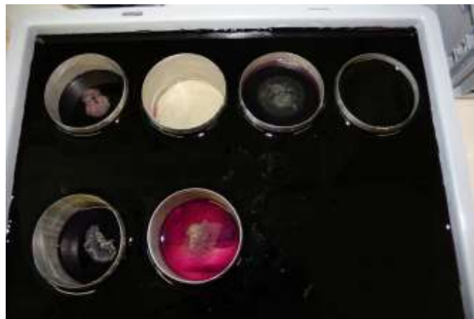
Abbildung 5: Ermittlung des NOD mittels Durchströmung von teils in ungestörter Lagerung gewonnenen Stechzylinderproben (Kaliumpermanganatlösung mit 10 g/l)
