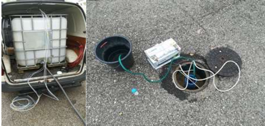
Abbildung 52: Einspeisung der Tracer in Zwölfaxing. Linkes Bild: 1000L Tank im Bus; Rechtes Bild: Beprobungsbrunnen während der Beprobung.
