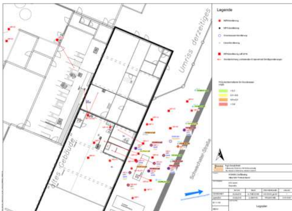
Abbildung 32 Ergänzende MIP-Kampagne. Lageplan der Vertikal- und Schrägsondierungen
