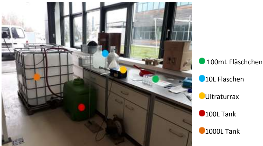
Abbildung 51: Aufbau zur Lösung der Tracer im Labor für den Feldeinsatz.
