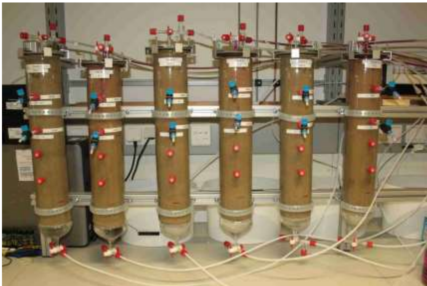
Abbildung 14: Säulenversuch zur Ermittlung des PCE-Austrags aus einem mit PCE-dotierten Kern
