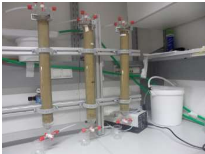
Abbildung 20: Foto des in Betrieb befindlichen Säulenversuches zur Charakterisierung der eingesetzten Partitioning Tracers
